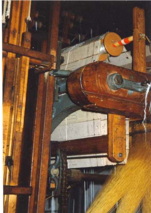
Abbildung 1.1: Die Lochkartensteuerung der Jacquard-Maschine.
