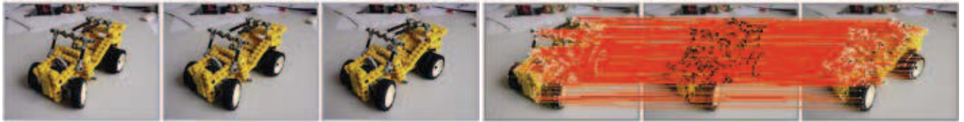
Das von Professor Peters entwickelte System zur Freihanderfassung sucht auf drei Fotos eines Gegenstands nach markanten Punkten. Insbesondere solche Punkte, die auf Ecken und Kanten liegen, werden auf allen drei Bildern erfasst, und zueinander ins Verhältnis gesetzt.
