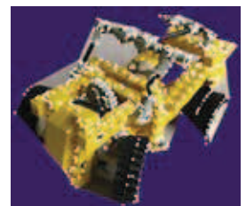
Aus korrespondierenden Punkten generiert das System eine Punktwolke und verkleidet dieses „Gerüst“ mit der entsprechenden Oberfläche.
