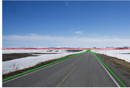
Abbildung 1.8: Fluchtpunkt und Gerade im Unendlichen. Im euklidischen Raum parallele Geraden, wie hier die Außenseiten einer langen geraden Straße (grün), schneiden sich nach der projektiven Transformation in einem Fluchtpunkt. Der Fluchtpunkt liegt auf einer endlich abgebildeten Geraden im Unendlichen (rot), auch Horizont genannt.
