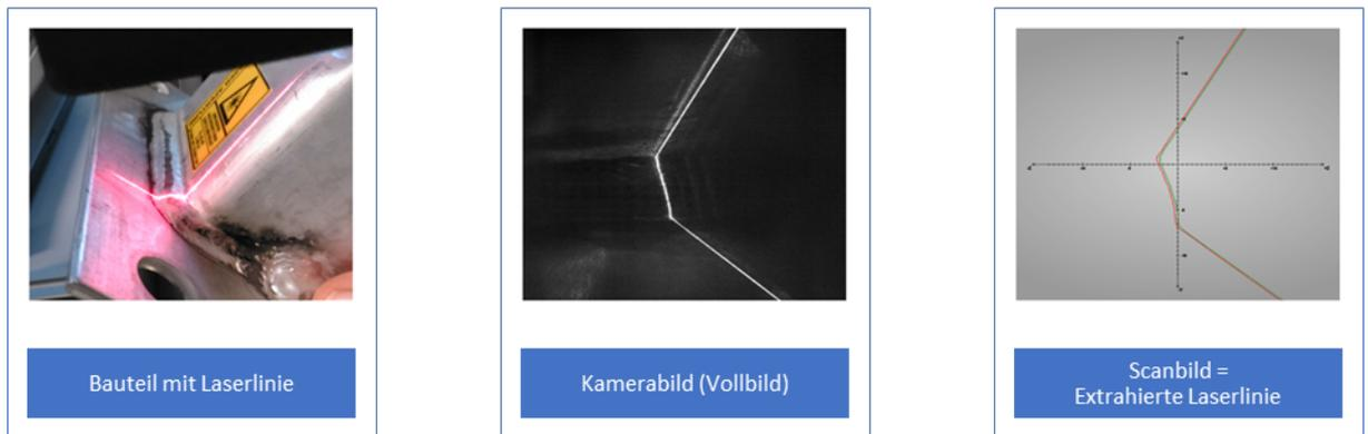
Abbildung 7: Vom Bauteil zum Profil
