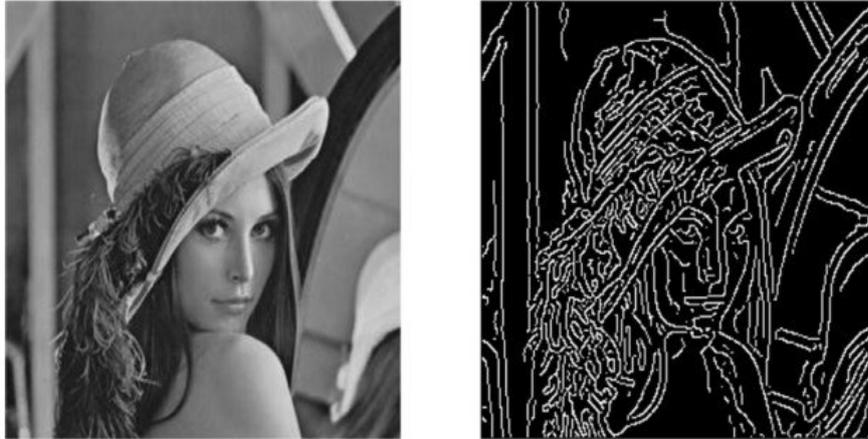
Abbildung 17: Lena und Canny Edge basiertes Bild [ADAA16]
