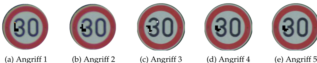
Abbildung 13: Berechnete Angriffe, bei denen nur 1 % der Pixel manipuliert wurden und die bei allen Systemen zu einer Fehlentscheidung führten.
